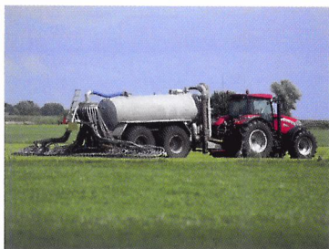
Afb. 1.70 Dierlijke mest wordt ingespoten in de grond, zodat er zo weinig mogelijk schadelijke gassen vrijkomen.
