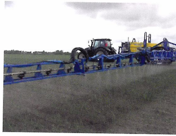
Afb. 1.74 Vloeibare kunstmest wordt toegediend met een veldspuit.
