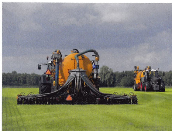
Afb. 1.69 Het toedienen van drijfmest gaat in Nederland met een zodenbemester.
